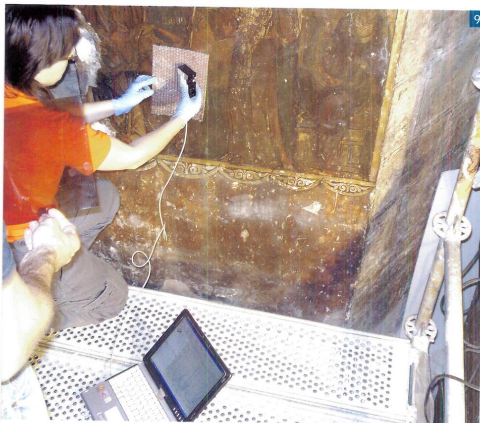
Figura 14: Estudios fotográficos previos. Rostro de Jesús. Las tomas fotográficas con UV permite determinar la presencia de una capa final, en este caso, de cera; su espesor y distribución sobre las pinturas.
